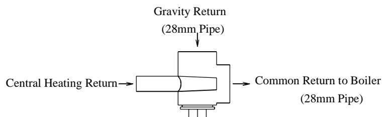
Fig. 7. Injector Tee.
