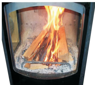
Fig. 3. Etablissement du feu - La commande d'arrivée d'air est tirée au maximum
